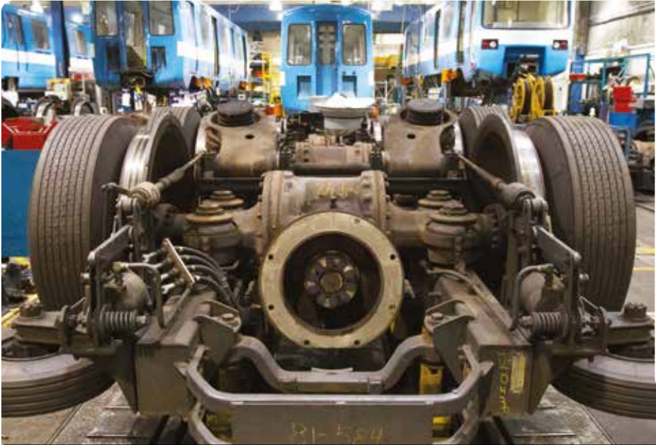
Un bogie retiré d'une voiture MR-63 duquel on gardera les pièces pouvant être utiles, soit pour un autre MR-63 jusqu'à son rebutage d'ici la mi-2018, soit pour un MR-73.
